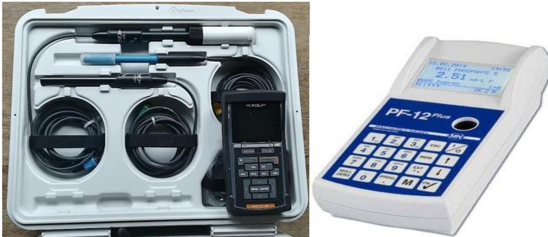
Figure 12 : Boitier multiparamétrique WTW à gauche et Photomètre utilisé à droite (modèle : PF12).
