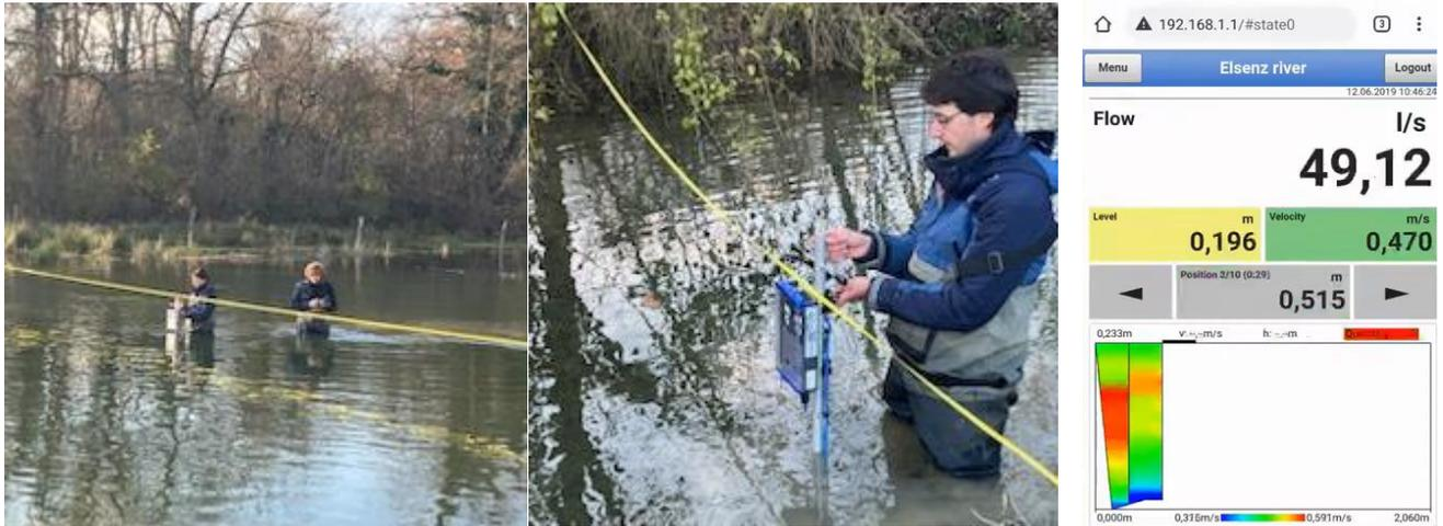
Figure 16 : Application de jaugeage (à gauche) et exemple d'interface smartphone de l'acquisition terrain du NivusFlowStick (à droite)
