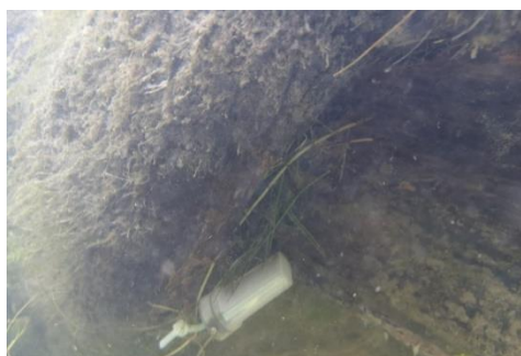
Figure 2 : Sonde thermique installée.
